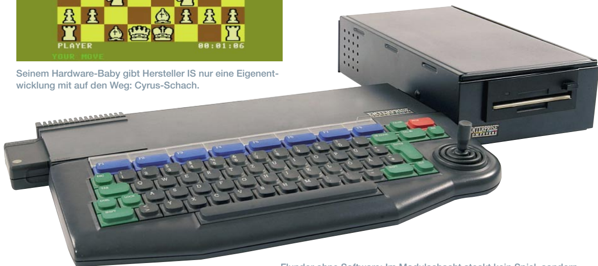
Flunder ohne Software: Im Modulschacht steckt kein Spiel, sondern eine Speichererweiterung. An die andere Seite kommt ein Floppy-Laufwerk.
