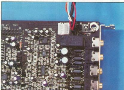
Nachgedacht: Da die Stecker für das Audio-Kabel eines CD-Laufwerks nahe dem Slot-Steck sitzen, reduziert sich der Kabelverlauf im Rechner. Das Kabel muß nicht für jede neue Karte abgesteckt werden.
