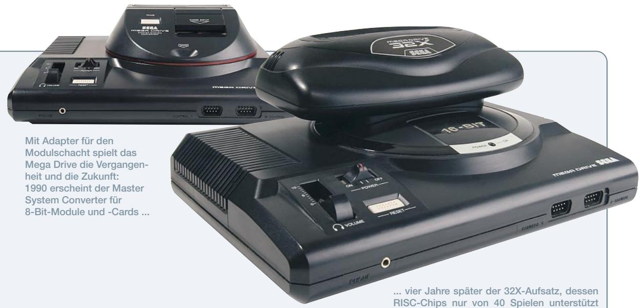
Mit Adapter für den Modulschacht spielt das Mega Drive die Vergangenheit und die Zukunft: 1990 erscheint der Master System Converter für 8-Bit-Module und -Cards ...
