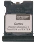
Microdrive, ein digital beschreibbares Magnetband im Mini-Cartridge mit einer Übertragung von 5 K/s (Sinclair, 1984)
