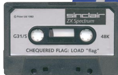
Audio-Kassette mit 10 Minuten Laufzeit, zur Sicherheit beidseitig bespielt – ein analoges Speichermedium (Psion, 1983)
