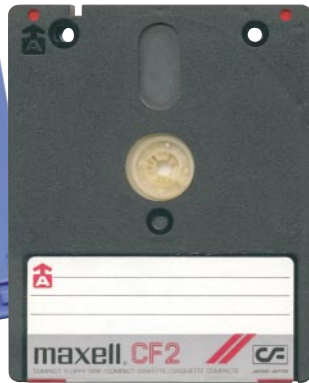
3"-Compact-Diskette, eine exotische Floppy-Variante für englische Heim-Computer (Maxell, 1985).
