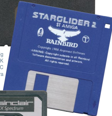
3,5" Diskette, einseitig, rund 800 K. Die Disk ist entweder für ST oder Amiga formatiert, nicht mit zwei „Star Glider 2“-Versionen beschrieben (Argonaut, 1988)
