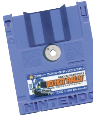
Famicom Disk: Die 2,8"-Floppy wird in Japan beschreibbar oder bereits bespielt verkauft (Nintendo, 1988).
