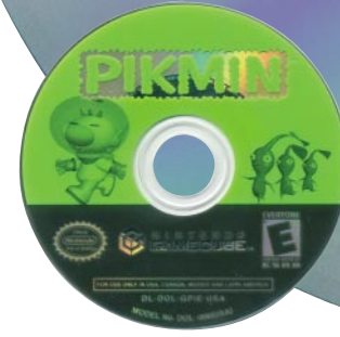
Mini-DVD für den Gamecube, mit einer Kapazität von 1,5 G von Matsushita entwickelte (Nintendo, 2002)
