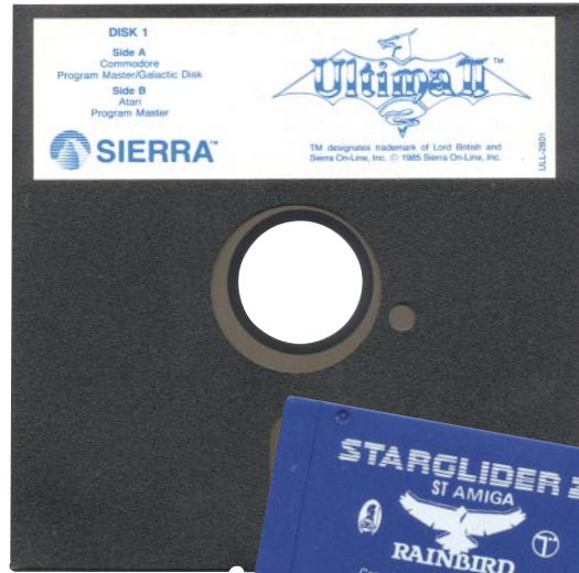
5,25" Diskette, beidseitig beschrieben, rund 100 K pro Seite: Floppy für C 64 und Atari 800 (Sierra Online, 1985)
